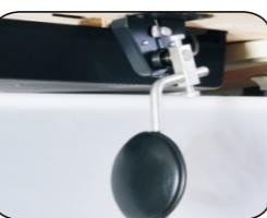
**电子膝靠**：不改变工人的操作习惯，实际轻松抬压脚。
