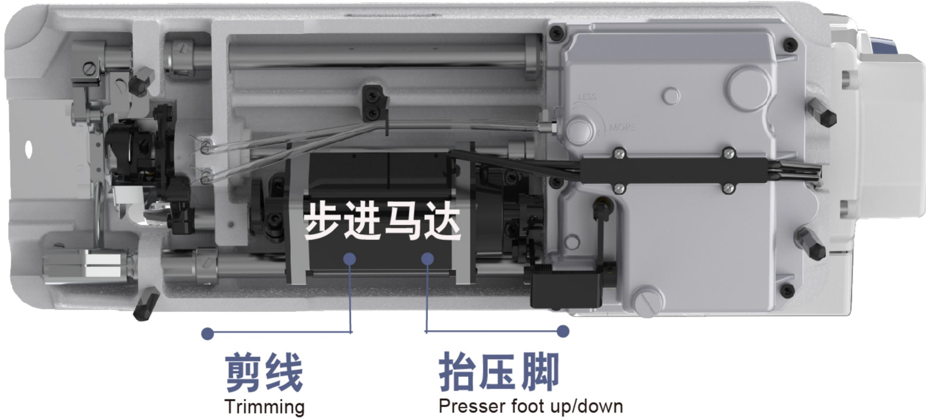
步进电机双向控制：一个电机控制抬压脚与剪线(专利技术)，方便压脚高度调整,压脚升降无噪声,剪线平稳顺畅.
